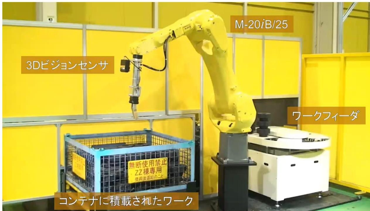
ばら積み(Random Pickup)では、事前に対象の位置を正確にプログラム（ティーチング）できないため、画像などに基づいたフィードバックと、動作計画をリアルタイムで実施する必要がある。つまり、**目が見える必要がある**
